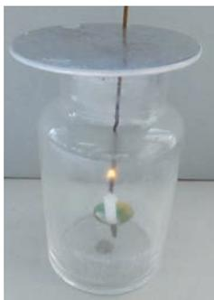
2. ふたをした集気びんの中では、ろうそくが燃え続けるか問いかけ、実験します。この時、炎の大きさの変化の様子、何秒くらいで消えるかについて、よく観察させます。燃える時間は、口で1、2と声をだしながら数えるようにします。
