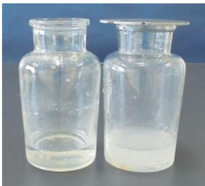
時間がたつと澄んできます。専用容器がない場合は、アルカリ耐性の容器に水酸化カルシウムと水道水を入れて振り、半日程度放置します。石灰は何回か使用すると性質が変わります。石灰水が反応しない時は、水酸化カルシウムを取り替えます。
